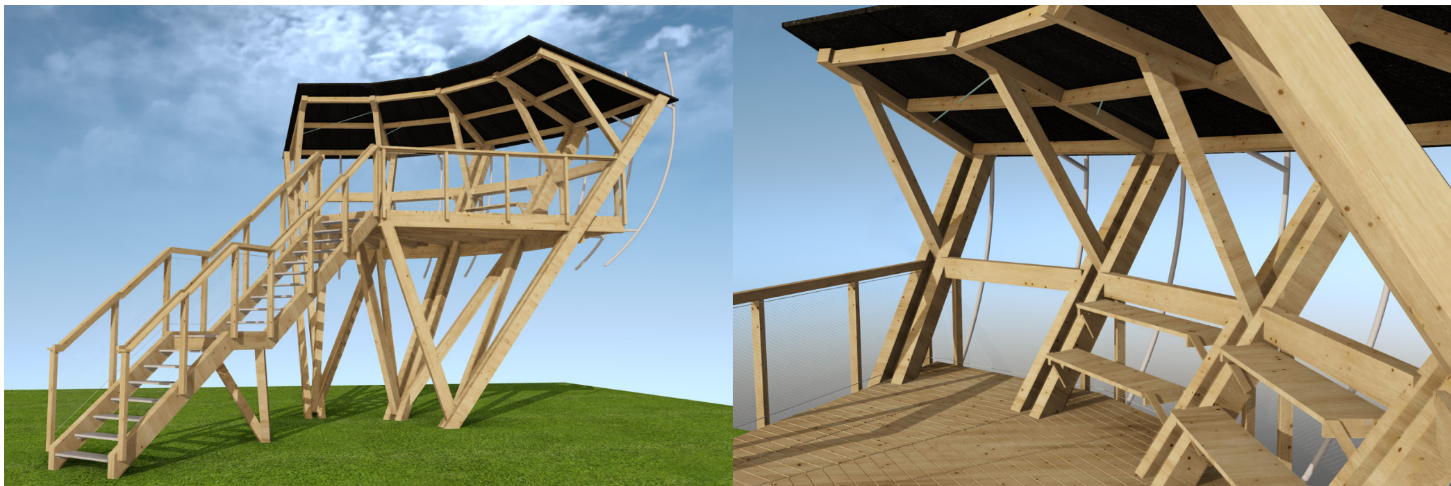
Modèle 3D de l'observatoire conçu pour accueillir 8-10 personnes simultanément. Le bardage extérieur en branchage n'est pas représenté.
