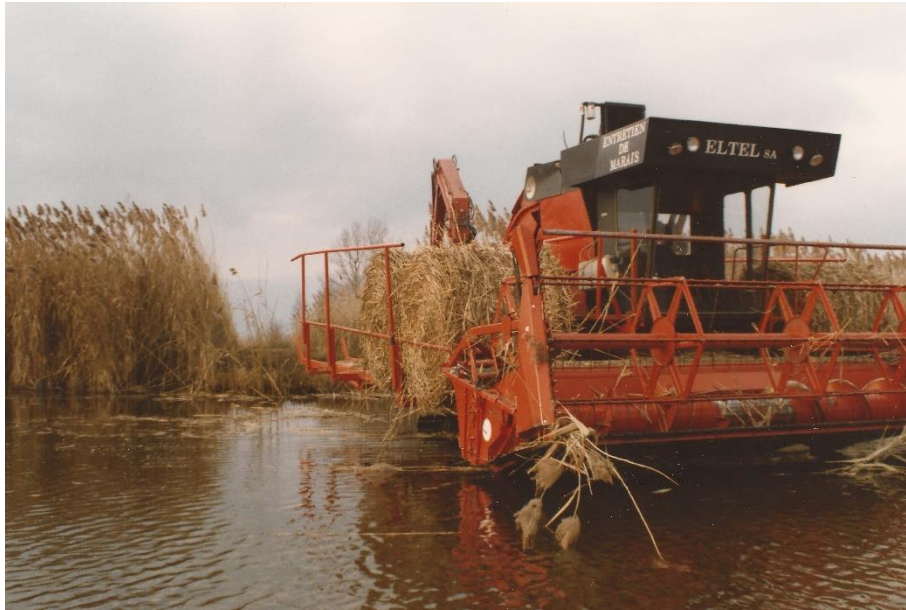
Figure 3.4.4_2 : ELBOTEL dans sa deuxième version en 1986 : une machine agricole de type moissonneuse-batteuse spécialement adaptée pour le fauchage des marais non-boisés les plus inondés de la Rive sud du lac de Neuchâtel
