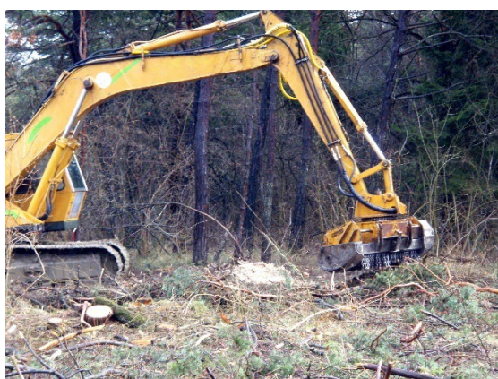
Figure E-MA_12 : Broyage mécanique des ligneux et état de la surface après traitement
