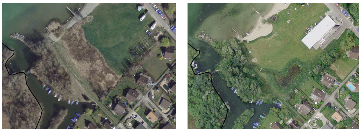
Figure E-EC_6 : Réaménagement de la plage de Cheyres. À gauche : état 2010. À droite : état 2013. Un biotope humide, visible au centre de la photo de droite, a pu être maintenu lors du remblayage d'une bande de roselière située en dehors du périmètre statuaire de l'AGC marqué par la limite de la Réserve naturelle de la Baie d'Yvonand, en noir à gauche des photos. La connectivité avec la réserve de Cheyres voisine a été renforcée par la protection/replantation d'un cordon boisé à l'arrière du nouveau restaurant aménagé sur la plage.
