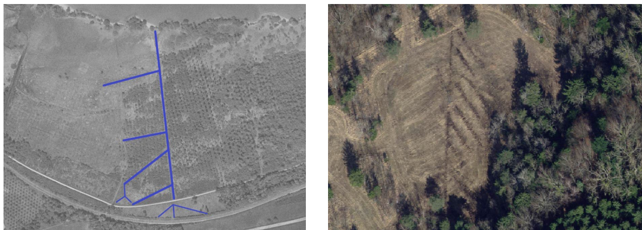
Figure E-AL_2 : A gauche : en bleu, réseau de drainage dans une peupleraie de la réserve naturelle de la Baie d'Yvonand, années 1960. A droite : reliquat, en 2017, d'un réseau de drainage dans une clairière de la réserve naturelle des Grèves d'Ostende et de Chevroux
