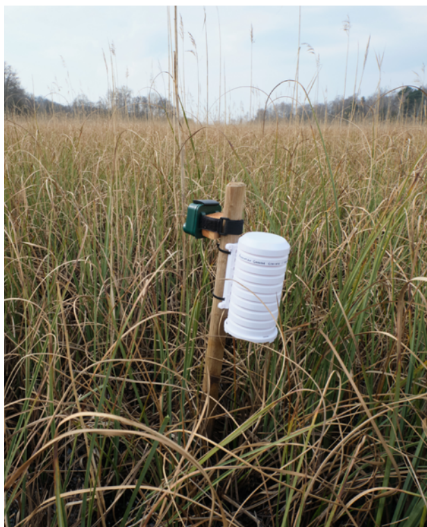
Enregistreur Audiomoth (petit boîtier vert) placé dans les marais de Cudrefin pour détecter les Marouettes ponctuées Porzana porzana et les Rainettes vertes Hyla arborea , le 26 mars 2025. Le grand boîtier blanc abrite un enregistreur d'humidité et de température de l'air.
